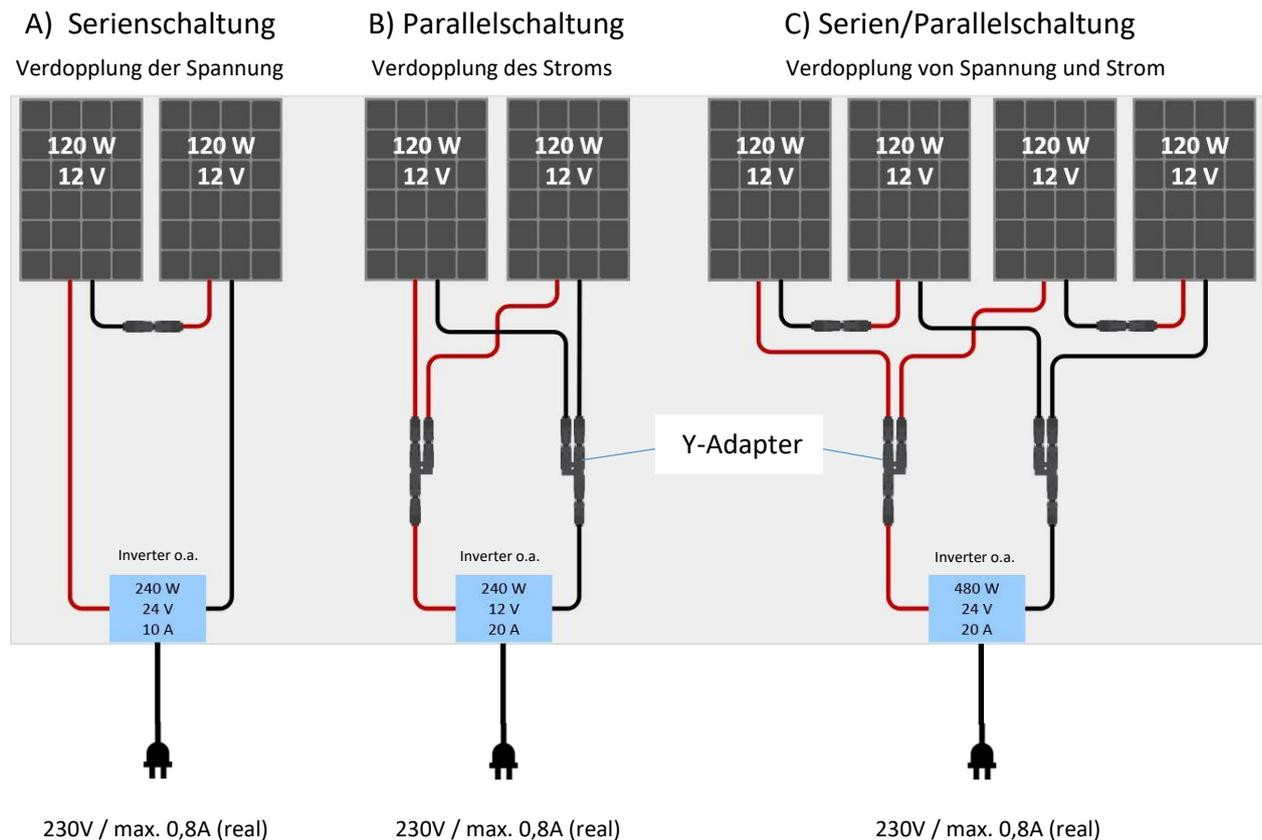
Parallelschaltung von weiteren 2er Modulreihen nach Schema C) je nach Leistung des Inverters oder Speichers beliebig möglich (2, 4, 6, ...).
